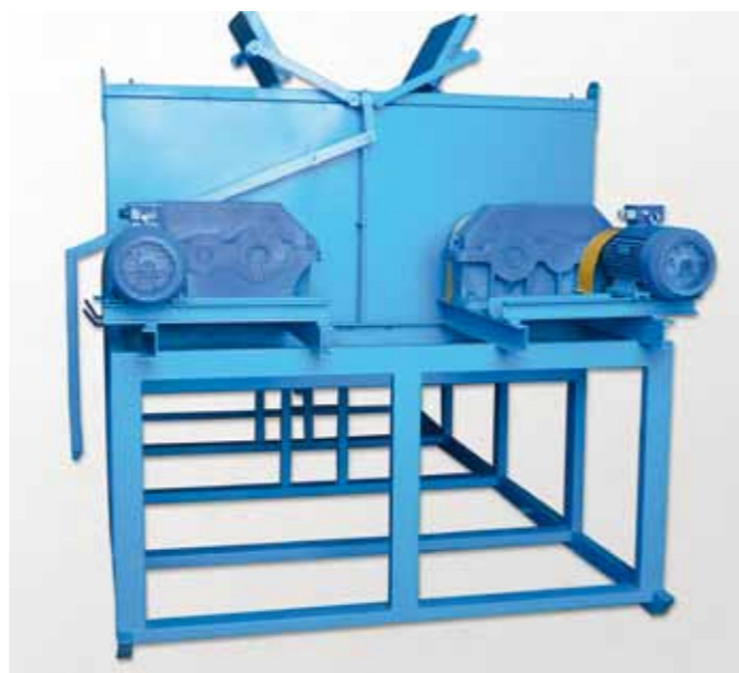
Рис. 1. Установка СМФ для производства белковых кормов из растительных отходов.
