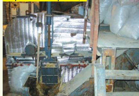
Рисунок 1. Запарник-смеситель кормов С-3,0
