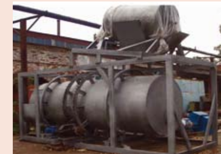
Рис. 2. Ферментеры на 0,7 и 7 м 3
